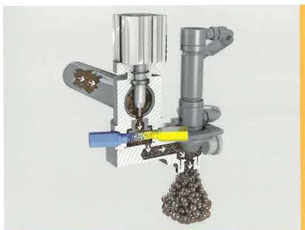
Schema della produzione del bitume schiumato
