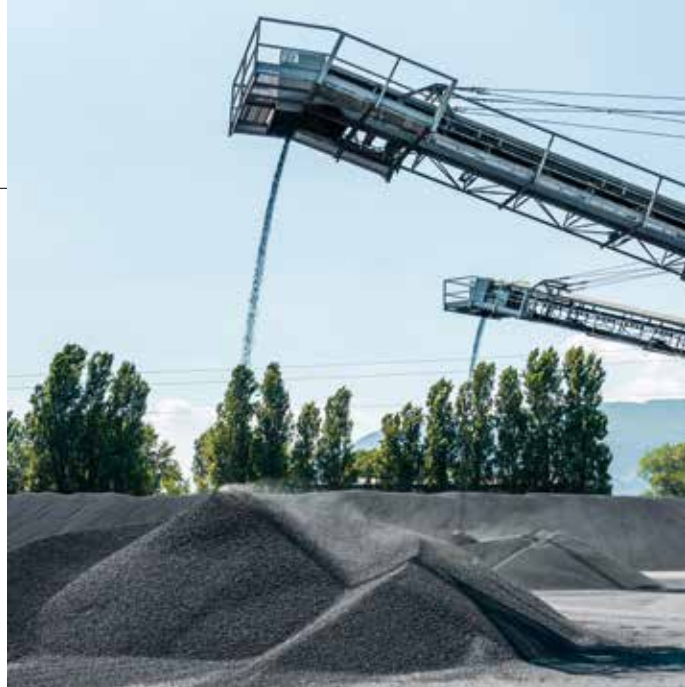
3. Impianto di produzione Granella®, materiale ottenuto dalla lavorazione di residui non metallici di acciaieria
